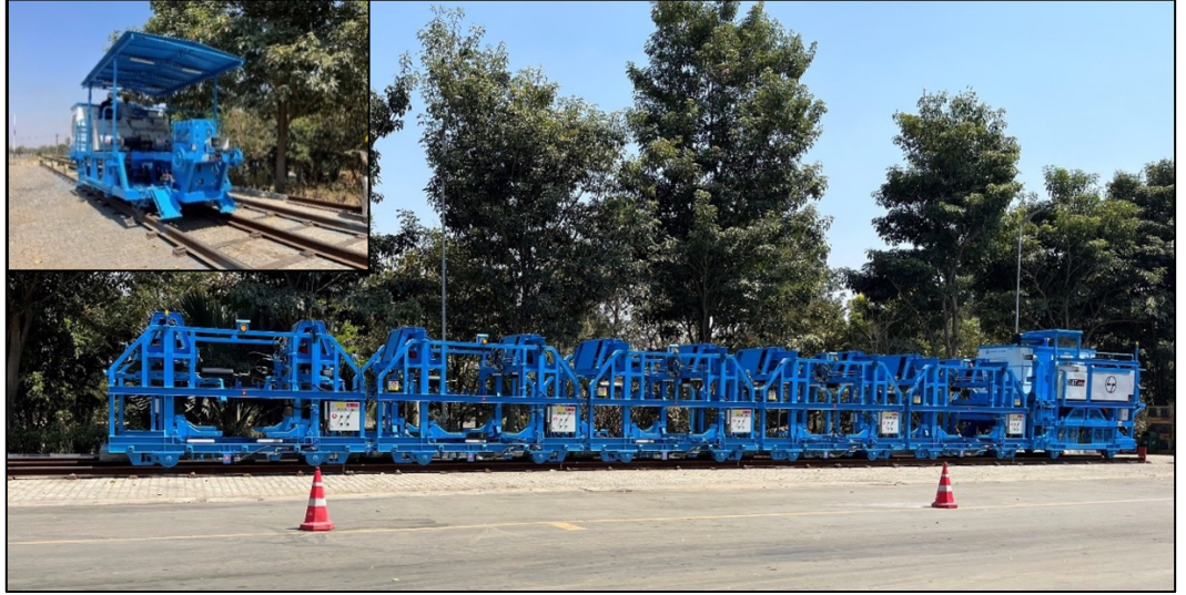
રેલવેના પાટાનું કામ (પેકેજ ટી2) - ટ્રેક સ્વેલ લેયિંગ કાર અને રેલ લેયિંગ કાર (ઇનસેટમાં), ગુજરાત
